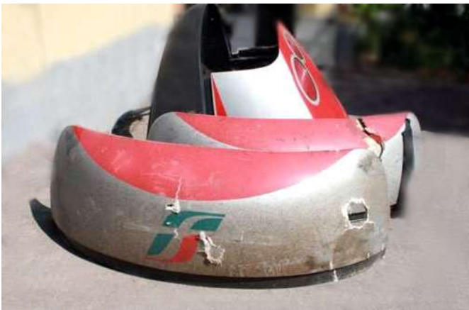
Reparation of ETR 500 parts, Freccia Rossa.
